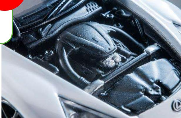
2009年に発表、翌年より販売開始されたレクサス初のスーパースポーツカーが「LFA」です。フロントエンジンながらリア側に置いたラジエーターやトランスアクスル化などで前後重量配分48:52を実現したパッケージ、専用開発のV型10気筒エンジン、カーボンとアルミを組み合わせたボディなど各所に当時最高の技術が投入され、生産も新設された「LFA工房」で行うなど、すべての面で妥協のない車両となつたLFAは、レクサスのプレミアムスポーツ「F」シリーズの頂点として全世界で500台が限定販売されました。
